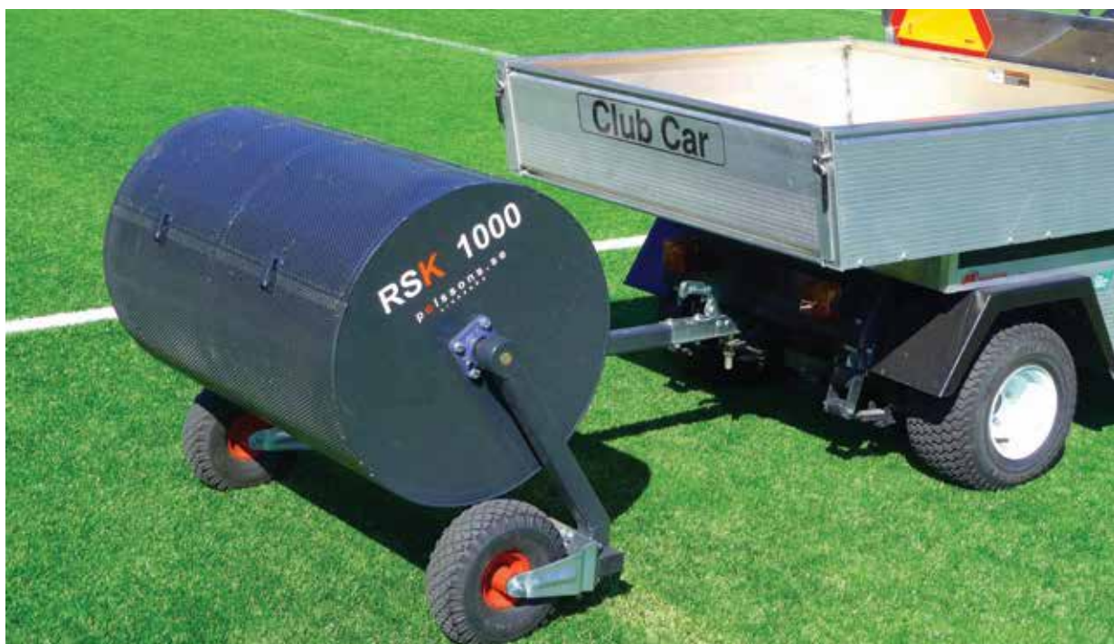
Granulaten grovrenses og legges ut igjen i kunstgressbanen. Foto: TF-Sport AS.
