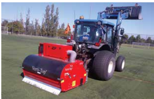
Dyprens utføres etter at grovrenset granulat er tilbakeført i banen. Foto: Hako Ground & Garden.
